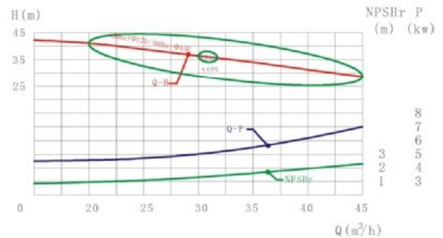
测试条件：介质清水，温度20℃，叶轮转速2900 R.P.M
