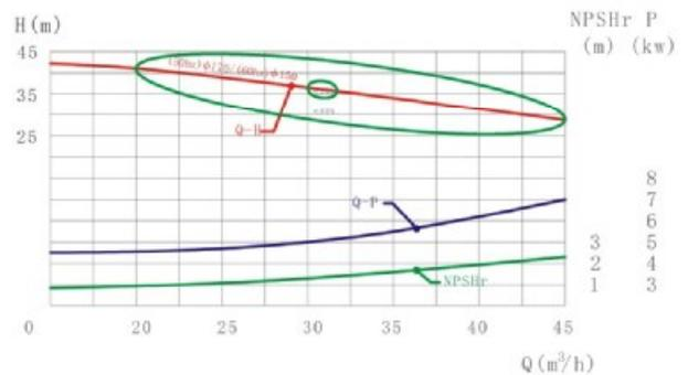
测试条件: 介质清水, 温度20°C, 叶轮转速2900 R.P.M (此曲线图亦适用电机60Hz, 叶轮转速3600R.P.M) Q-流量(m³/H),
