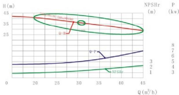
测试条件: 介质清水, 温度20℃, 叶轮转速2900 R.P.M
