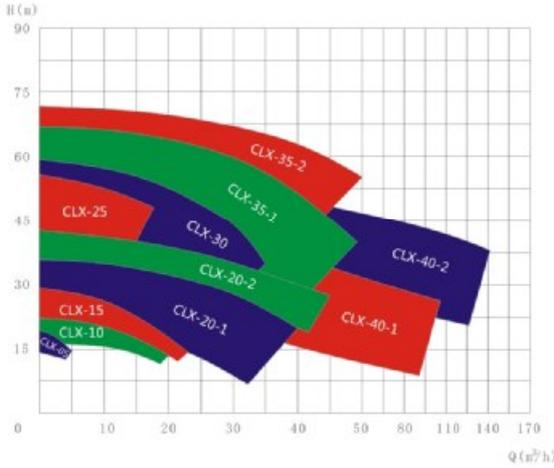
测试条件: 介质清水, 温度20°C, 叶轮转速2900 R.P.M
