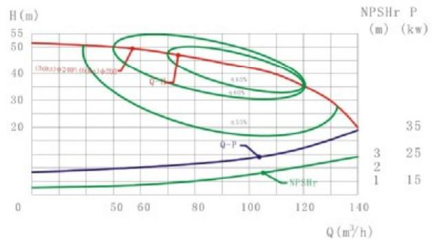
测试条件: 介质清水, 温度20℃, 叶轮转速2900 R.P.M (此曲线图亦适用电机60Hz, 叶轮转速3600R.P.M) Q-流量(m³/h), H-扬程(M), P-功率(KW), η%-泵效率。
