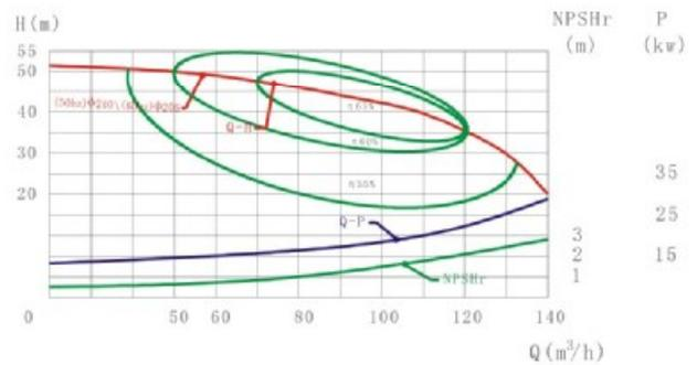
测试条件: 介质清水, 温度20℃, 叶轮转速2900 R.P.M (此曲线图亦适用电机60Hz, 叶轮转速3600R.P.M)
