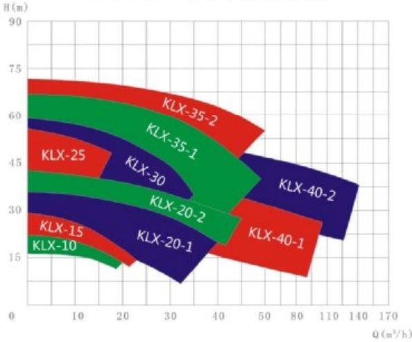
测试条件: 介质清水, 温度20°C, 叶轮转速2900 R.P.M
