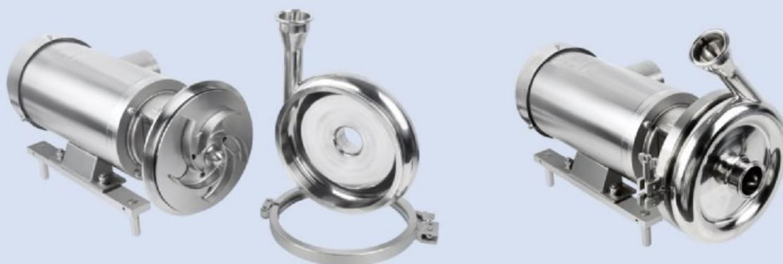
DONJOY DJ-SCLX离心泵是基于SKS离心泵基础上技术升级一款全不锈钢设计的离心泵，包含电机也是不锈钢，它不仅优化了内部结构、叶轮设计、死角处理、机封压力平衡设计且机封完全被处在冲洗区域。我们还对泵外部卫生也进行了优化，使其内部更加卫生、外部减少死角，由于没有死角区域，它非常容易被CIP清洗、SIP杀菌等。另外我们对DJ-SCLX系列泵保持了最大的灵活性组合应用，如，泵出口角度可以从0°-360°之间任意调整，泵盖采用卡箍式连接，这样对泵维护和保养及机封的更换，保持了高效，降低了人员高度专业性的要求，而完成这些无需特殊的工具。因而达到了、高效、卫生、高可靠性及低成本的目的，使DJ-SCLX系列离心泵成为一款高性能的泵。
