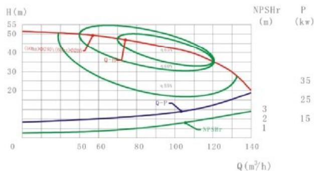
测试条件: 介质清水, 温度20°C, 叶轮转速2900 R.P.M
